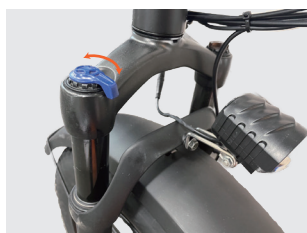
グリップでON/OFFを切り替えの サスペンションを搭載
